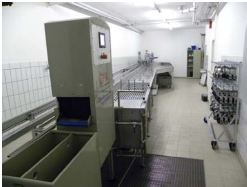
Neue zentrale Schlauchpflegeanlage für die FF Simbach unter Einbindung des bestehenden Schlauchturms
