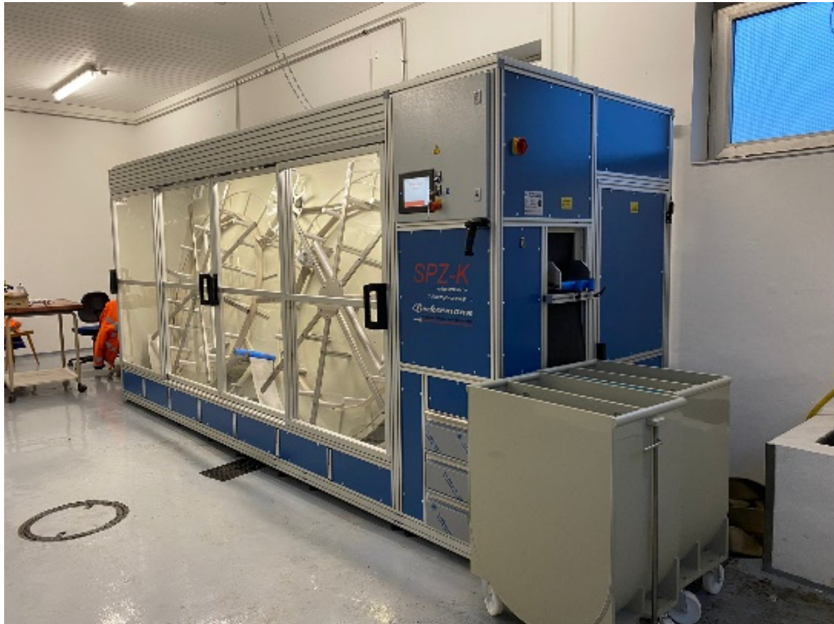
Schlauchpflegeanlage der Gemeinde Moosthenning
