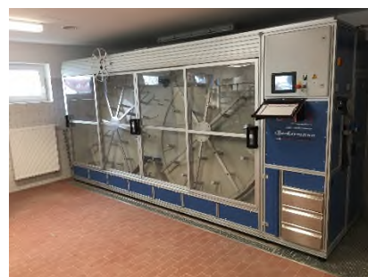
Schlauchpflegeanlage Markt Reisbach
