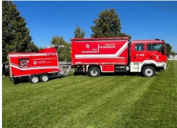
100 kVA-Stromerzeuger mit V-LKW der FF Eichendorf
