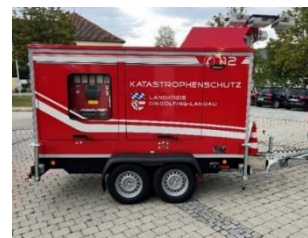
Stromerzeuger Landkreis 100 kVA bei FF Simbach
